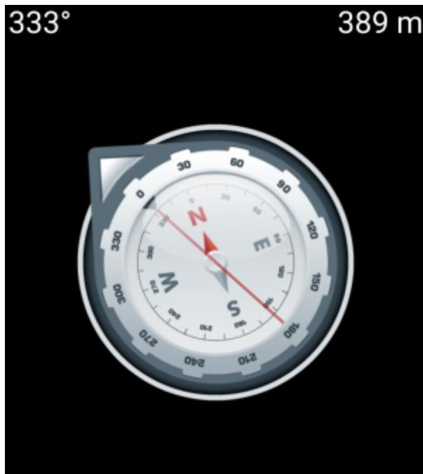
La ligne du haut montre le [relèvement](#) vers le nord et la distance par rapport à vos coordonnées cibles. La distance peut être affichée en miles (mi) ou en kilomètres (km) selon vos [paramètres](#).
